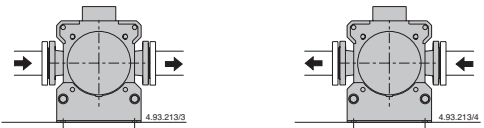
Variante 1: aspiración a la izquierda, impulsión a la derecha Variante 2: aspiración a la derecha, impulsión a la izquierda Fig. 2 Orientación de las bocas con la bomba horizontal
